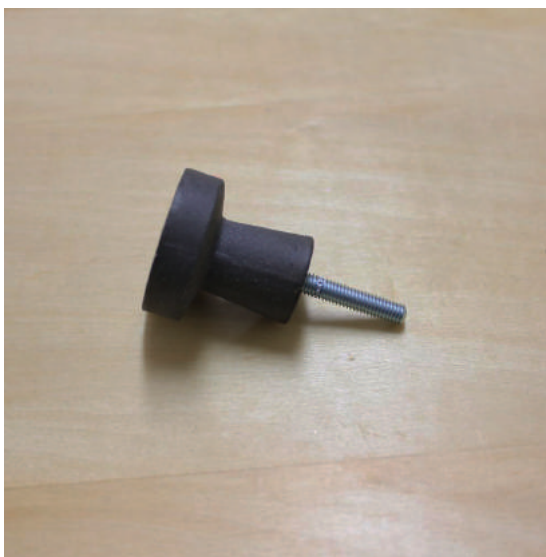
05_ つまみのネジ穴に、グラブスクリューの短い方をねじ込んでいきます。
